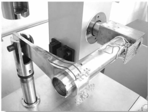
图 1 在 YDD - 1 试验机上安装试件
