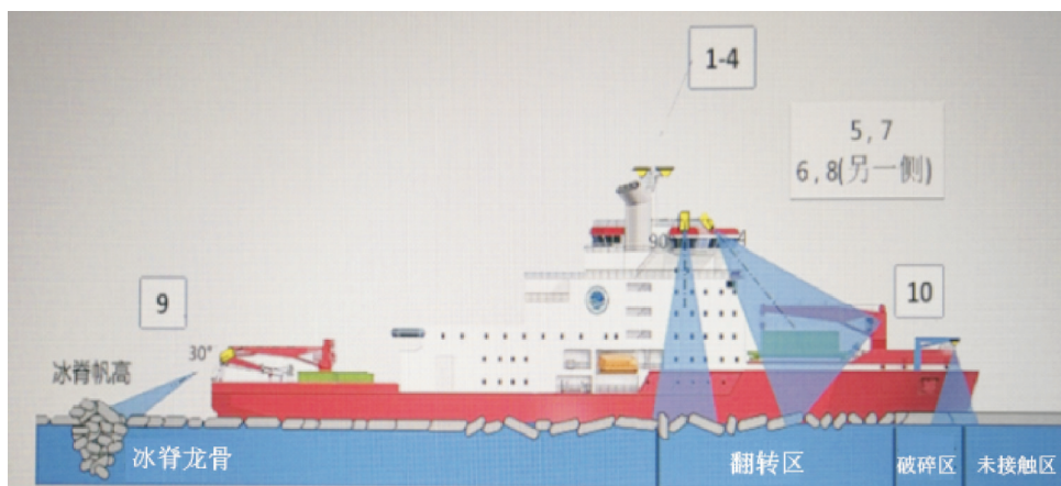
图8 破冰过程中碎冰4个运动区域
