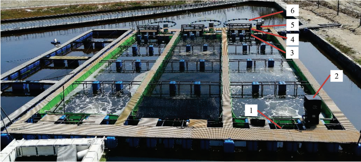
1-水射流器 Water jet machine;2-投饵机 Feeder;3-清污装置 Sewage disposal apparatus;4-循环晒网装置 Circulation drying net apparatus;5-控制柜 Controller cabinet;6-集污装置 Sewage collection apparatus
