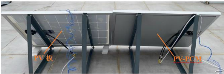
c)PV-PCM 装置实物图
