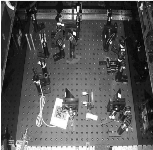
图 2 THz-TDS 系统示意图中虚线部分的照片
