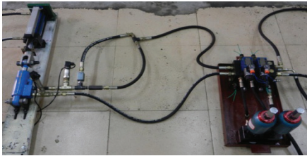
图 2 双气室悬挂缸实验台
