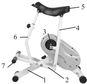
注：1—基座；2—连杆；3—惯性机构；4—平衡杆； 5—鞍座；6—活动杆；7—脚蹬杆 Notes: 1—Base; 2—Rod; 3—Inertia mechanism; 4—Balance rod; 5—Saddle; 6—Active rod; 7—Pedal
