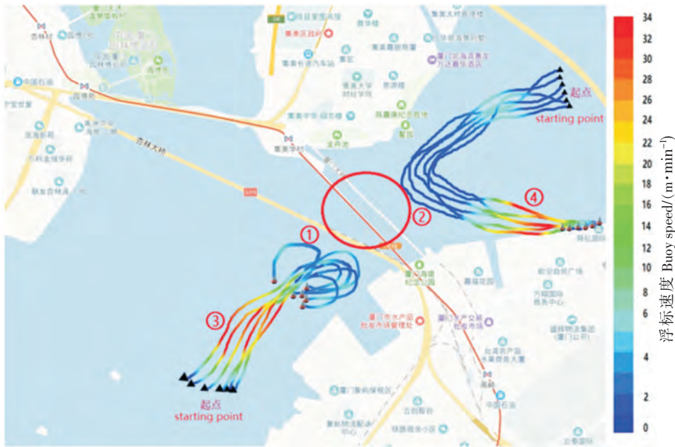
图 8 微型浮标轨迹及速度变化图
