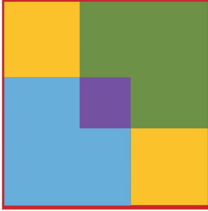
绿色和蓝色边框分别表示真实框 A 和预测框 B , 紫色表示 A 和 B 的交集, 红色包围框表示 A 和 B 的外接最小封闭框 C
