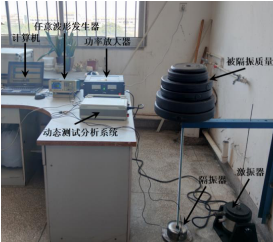
图8 振动传递率试验实物图
