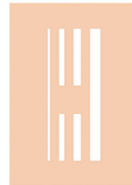
图 9 编码为 ID1001 无芯片标签的结构图
